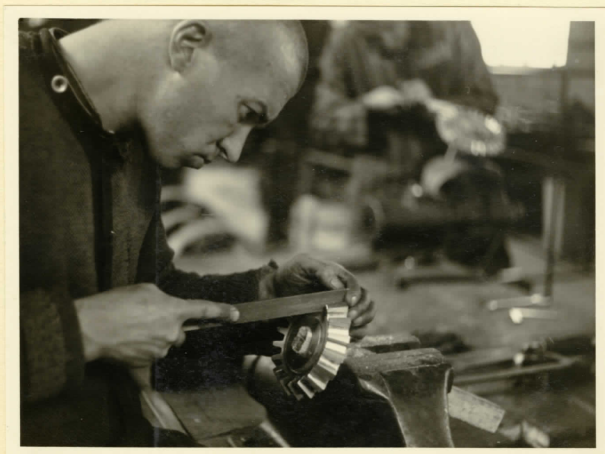
Beim Ausfeilen eines Kegetrades. Filing a bevel wheel.
