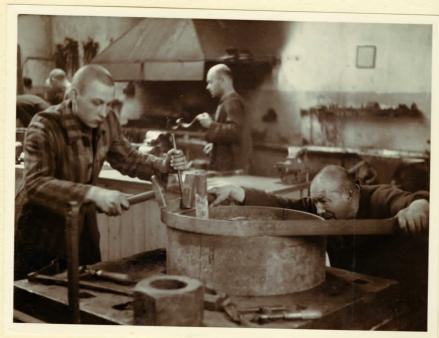
Fitting a tyre. Pusziehen eines Reifens.
