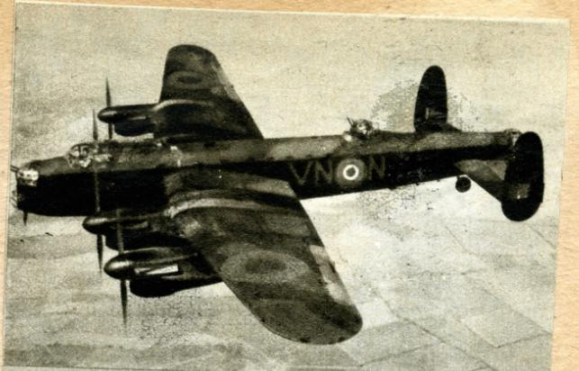
Le bombardier britannique « Lancaster » est celui qui échappe le plus facilement aux chasseurs de nuit du continent, cela grâce à sa vitesse de 500 km./h. et à son rayon d'action: 5000 km. avec 8 tonnes de bombes.
