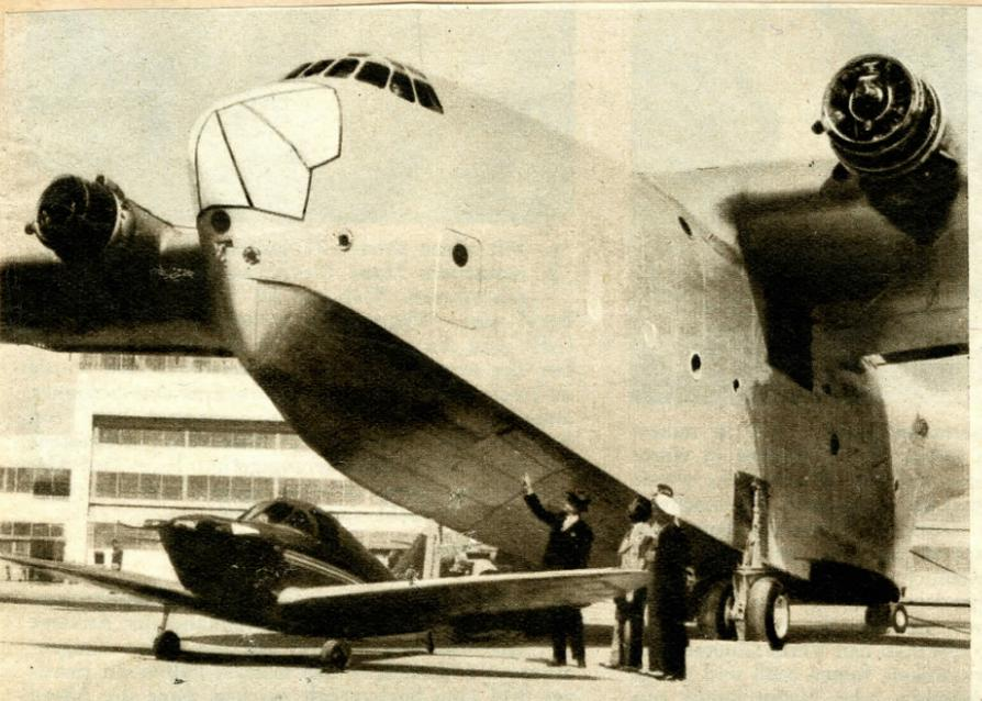
Revolution im amerikanischen Flugwesen. Bei diesem Luftriesen ist einzig der Motor aus Metall. Alles übrige besteht aus Mahagoniholz mit Asbestverkleidung. Die Maschine ist unverbrennbar und kommt in der Herstellung bedeutend billiger als Metallflugzeuge.
