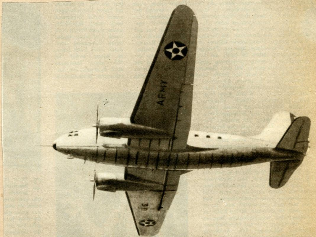
Dieser größte bisher erbaute Truppentransporter, eine 20-Tonnen-Curtiss-Maschine, wird ebenfalls in Amerika gebaut. In Tag- und Nachtschichten werden in den Curtisswerken diese Maschinen für die amerikanische Armee fabriziert. Sie sind ausgerüstet mit zwei 1700 PS-Wright-Motoren.
