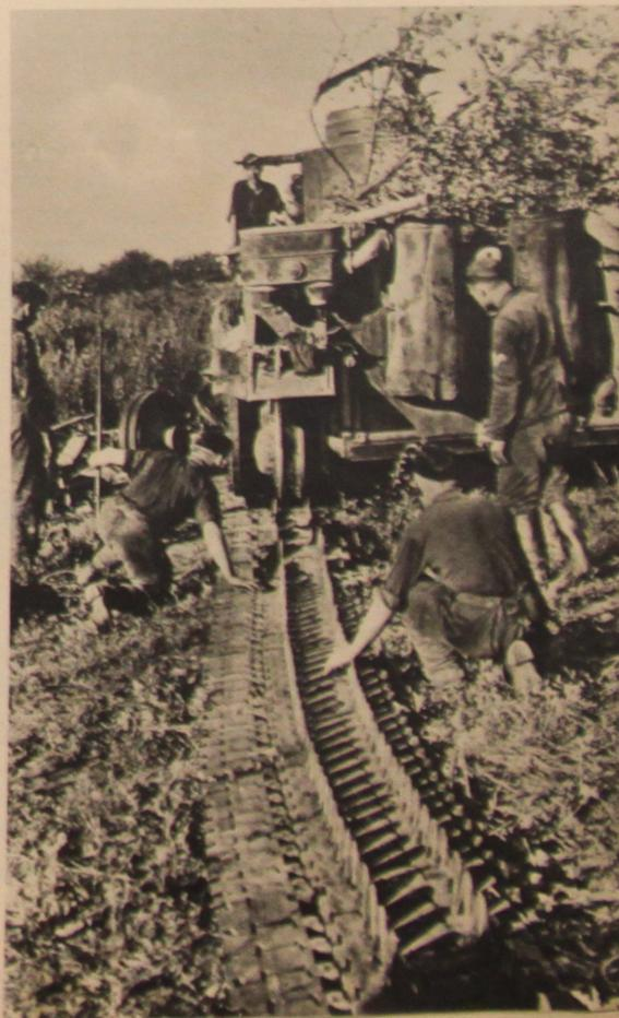
Mit Hilfe eines Kranwagens wird das beschädigte Treibrad gegen ein neues ausgetauscht
